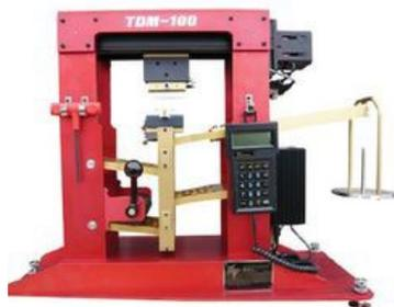
13997. Si **no hay desgaste de la cuchilla**, se mantiene el Couptest como test de referencia; no obstante, puede indicarse el nivel de resistencia según el test ISO 13997 de manera opcional. MAPA Professional ya ha estado aplicando el test más apropiado para describir los guantes de mayor resistencia al corte, el test ISO 13997.
